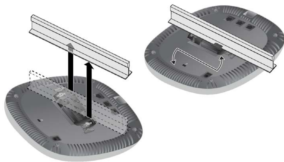
Figura 7 Montaje del punto de acceso
