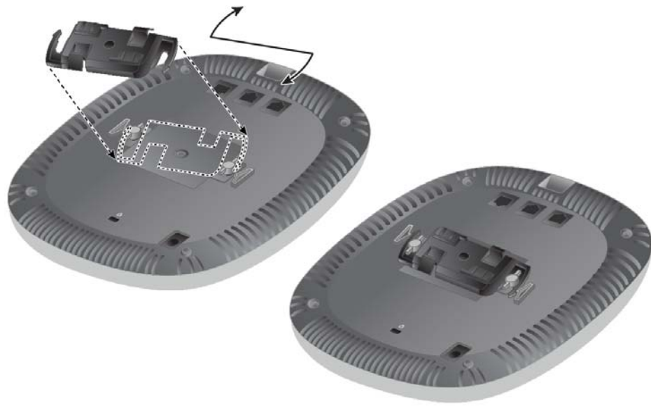
Figura 6 Instalación del adaptador para raíl de techo
